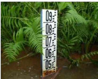
Photo 1 : Limnimètre installé dans le Bas – fond pour enregistrer les lames d'eau d'eau
